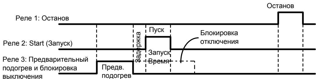
Рисунок С-4 Временная диаграмма режима StartStop
